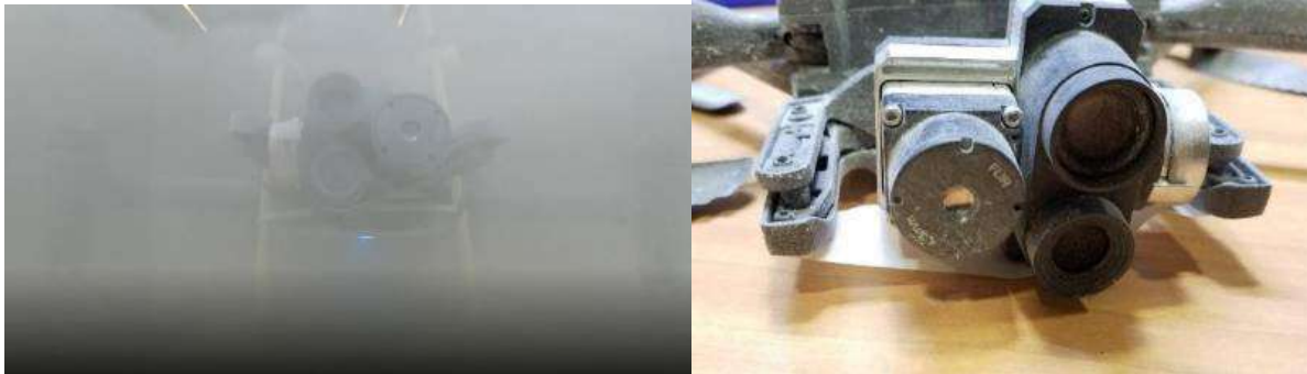
Fig. 7: IP5X test (sand)
